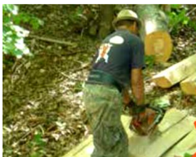
Absence d'EPI, utilisation incorrecte
