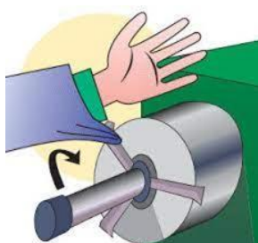
Entraînement : avec une partie saillante en mouvement
