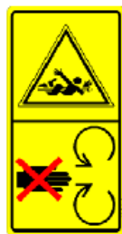
Danger d'entraînement de la main par le roulement
