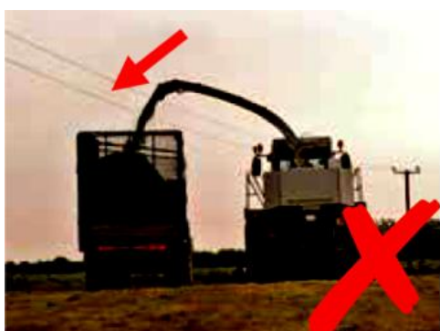
Câbles électriques non isolés
