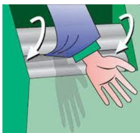
Presa: due rulli ruotano in senso contrapposto
