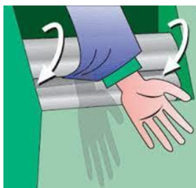
夹住：两个辊子以相反的方向旋转
