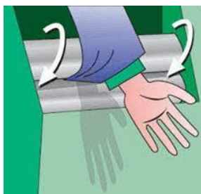
Złapanie: dwie rolki obracające się w przeciwnych kierunkach
