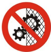
Zakaz usuwania osłon maszyny
