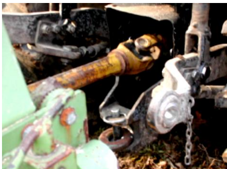
Niezabezpieczony wał Kardana
