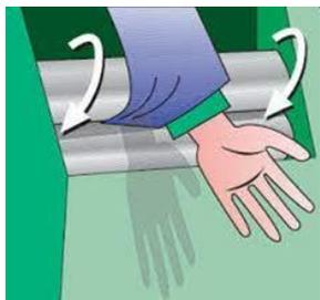
夹住：两个辊子以相反的方向旋转
